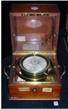
Illustration 5: chronomètre marine à suspension (XIXe)
